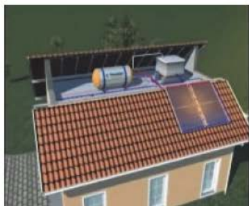
• Солнечный коллектор для нагрева воды, установленный на крыше дома
